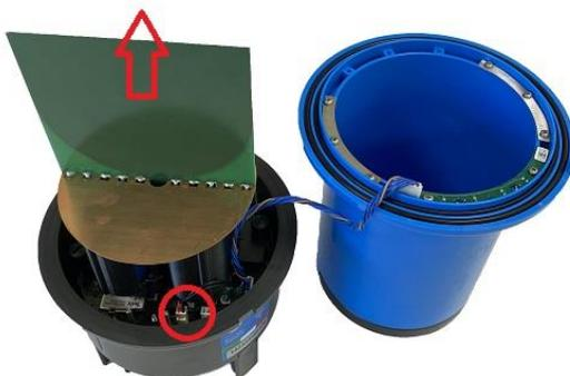
5. Svitare le due manopole di serraggio evidenziate in figura per rimuovere il supporto del pacco batterie:
