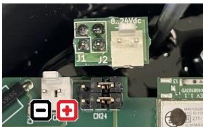
Tramite il connettore evidenziato in figura, è possibile alimentare il **Bjong** con una tensione di 3,6Vdc. Porre attenzione al rispetto della polarità indicata.
