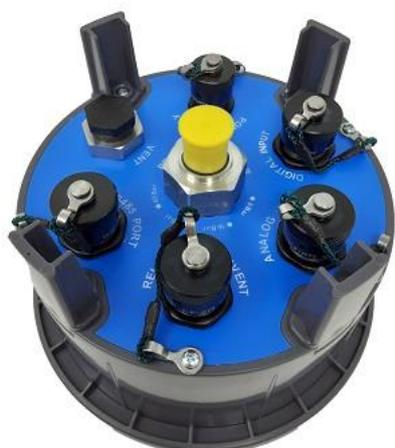
Tutti i connettori, disposti sul lato basso del **Bjong**, sono appositamente di dimensioni o polarità diverse tra loro in modo di facilitare l'utente al loro corretto cablaggio, questo accorgimento impedisce il collegamento di sensori/periferiche in ingressi non corretti.
